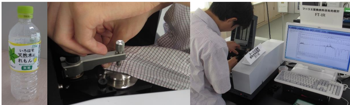
図1. FT-IR 測定の様子(左;PET ボトル、中;制服のシャツの測定、右;FT-IR 装置)
